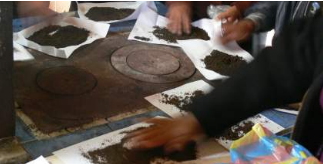
Secado de muestras de suelo. Muestra en sombra, sin estar expuesta a luz directa.
